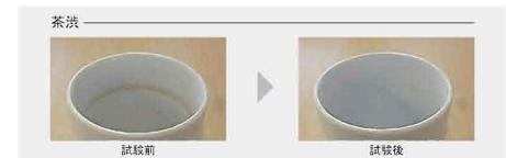
■当社試験条件 バイオパワー除菌<sup>※4</sup> / 洗浄水を約50℃に温めて洗剤を落かし(汚れと混ぜない)、50℃・2倍濃度洗剤溶液を1回スプレー
